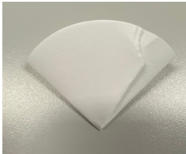
รูปที่ 3.12 การพับแบบกรวย (plain filter)
