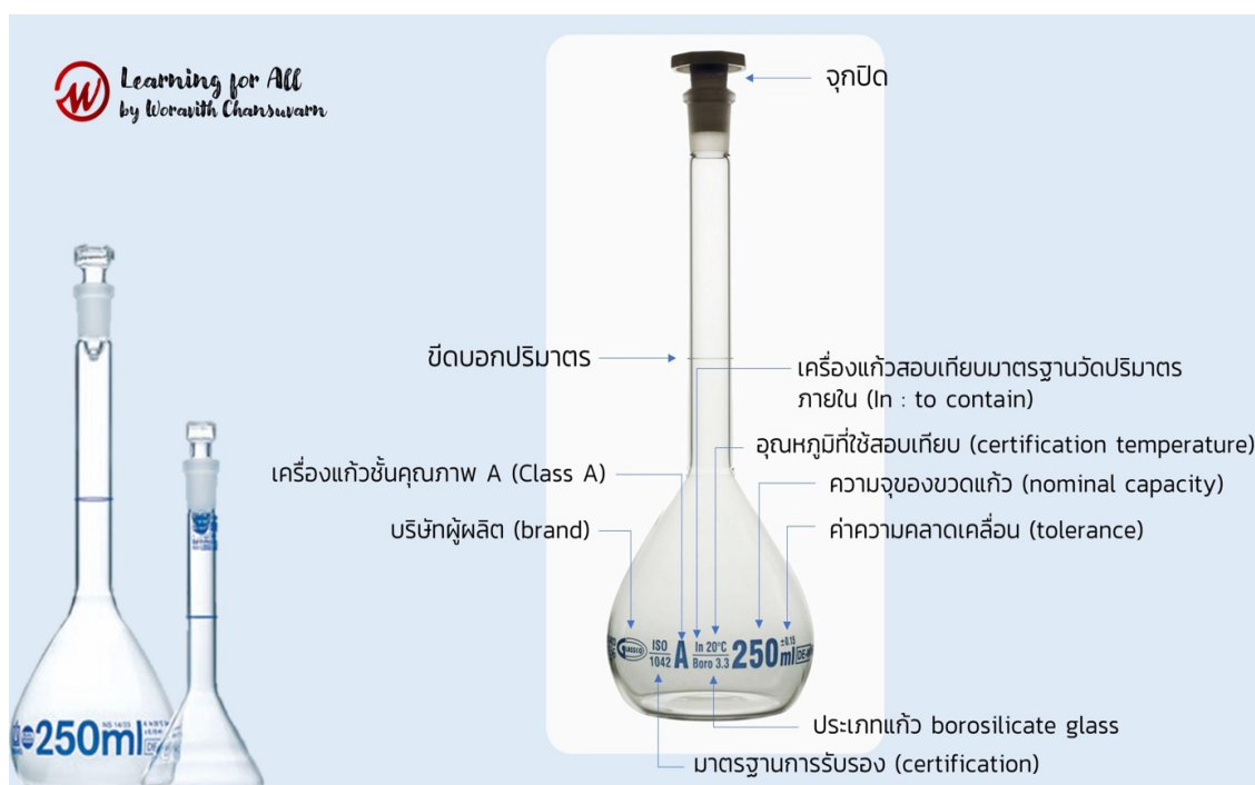
รูปที่ 3.2 แสดงตัวอย่างขวดวัดปริมาตร (Volumetric flask) Class A
