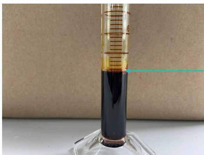
รูปที่ 3.19 การอ่านปริมาตรที่ส่วนโค้งสูงสุดของของเหลว
